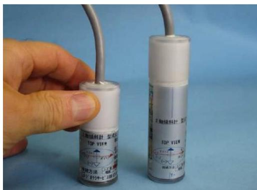
図 18 MEMS 技術を応用した傾斜計 (<http://www.geots.co.jp>)
