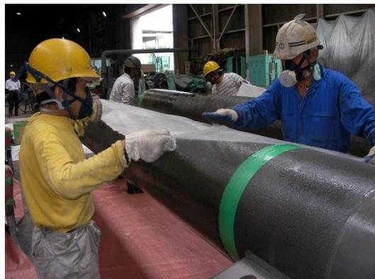
図 10 FRP を塗布中の遠心力鋳鋼管
