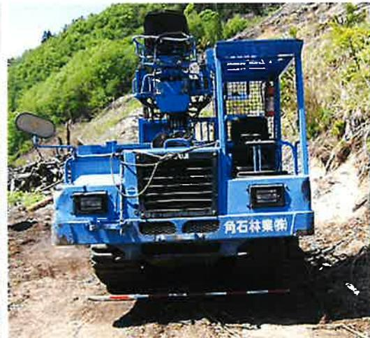
写真 3.75 履帯外幅 1990 mmのフォワーダ
