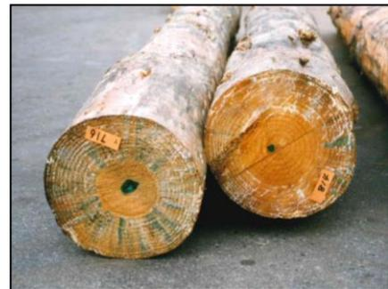
ラジアータマツの辺材に入った青変。中央部のきれいな部分が心材。心材率が低いことがわかる。
