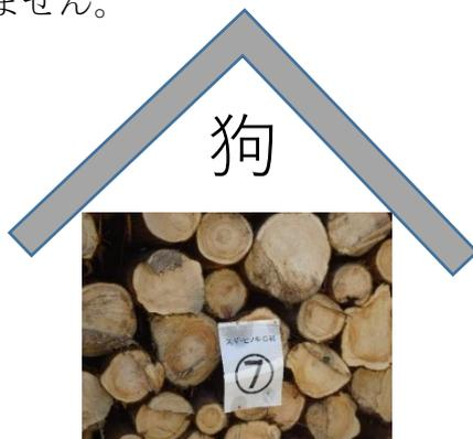
伐採されたヒノキのC材(A材、B材の次にランクされる低質材)。おいぬ様の御殿にはA材かB材が使われていたのかもしれない。
