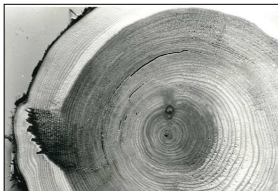
写真 25 目回りによる年輪に沿った割れ
