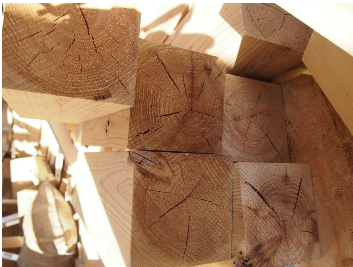
写真 2.3.2 内部割れを生じた製材品
