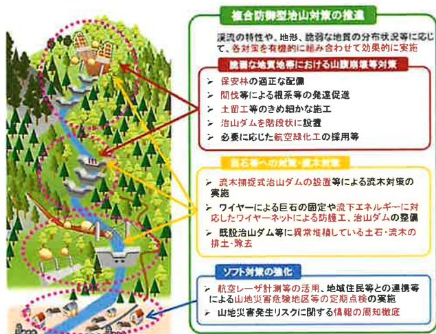
図 4.9.28 「複合防護型治山対策」の例<sup>13)</sup>(c) 谷出口に人家等の保全対象が近接している場合<sup>13)</sup>
