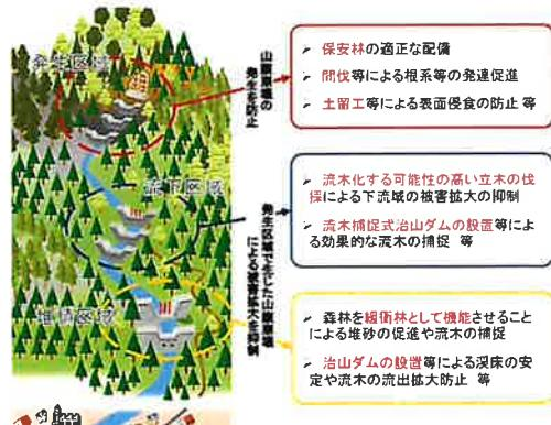
図 4. 9.24 土砂・流木の発生抑制および捕捉を行うための基本的な対策手法<sup>10)</sup>
