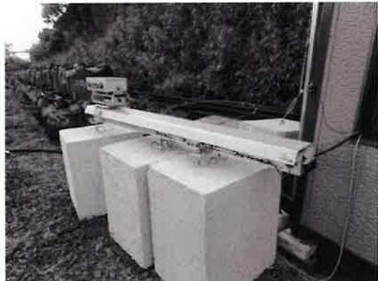
図 5.1.10 GB-SAR の計測状況の例
