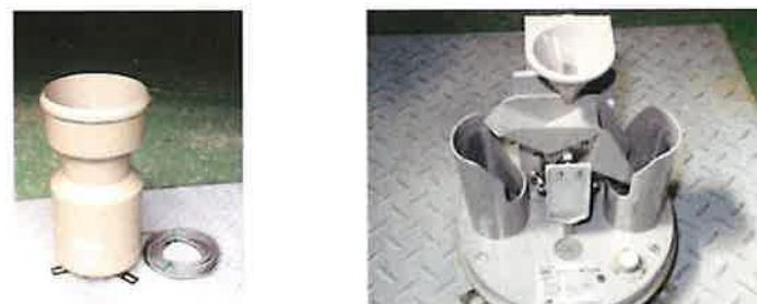
図 4.2.1 雨量計の外部と外観
