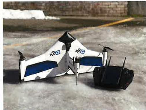
図 5. 1.7 鉛直離着陸型 UAV の例
