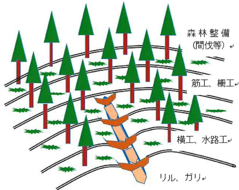
図 10.9.10 表層土壌侵食，侵食性崩壊に適する治山対策の例
