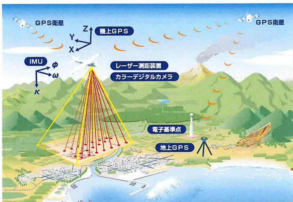
図 2-1 航空レーザ計測の概要
