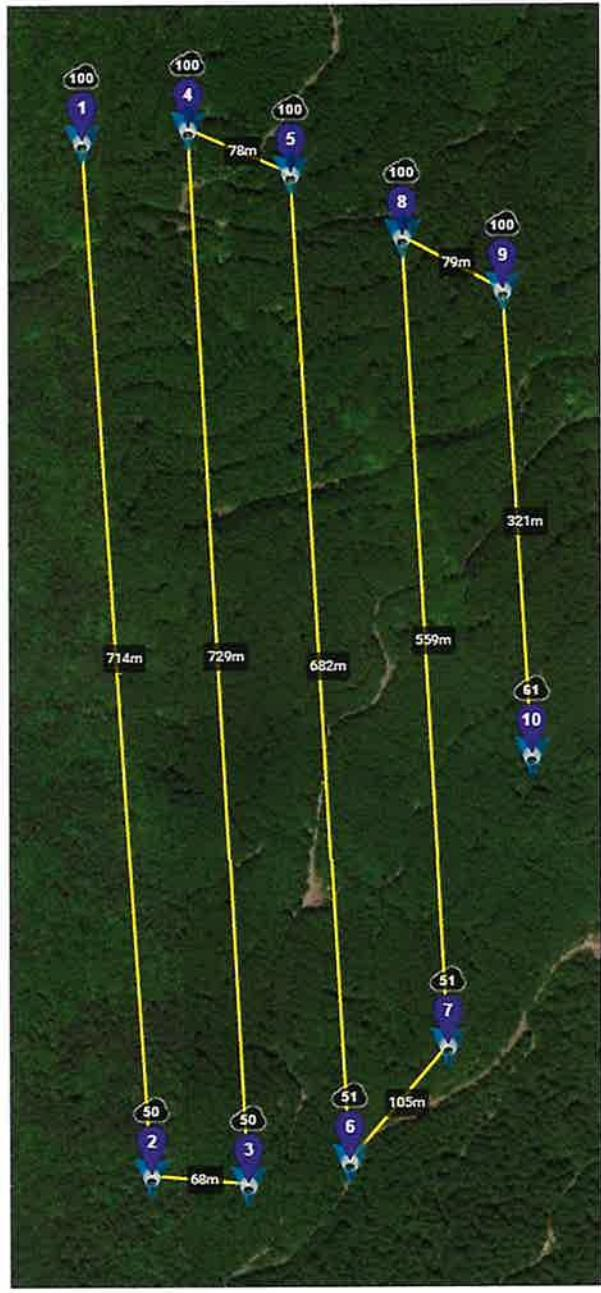
図 2-78 計画経路（左：高度 50m、右：高度 100m）
