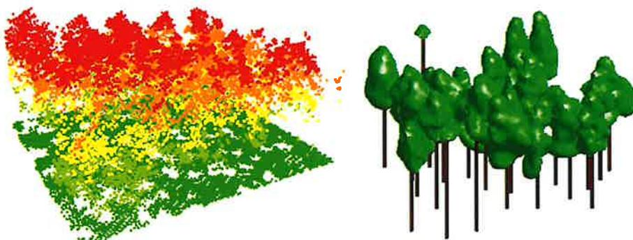
図 3-1 ラッピング法によってレーザーの点群から樹木形状を再現した例。
