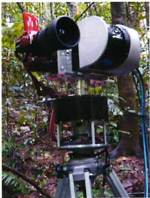
図3-2 本研究に用いた地上レーザー
