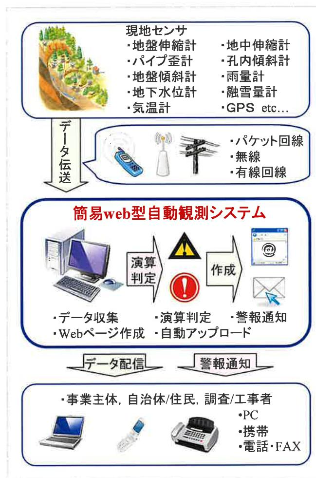
図3.3.2 Web型自動観測システム概要(国土防災技術2018)
