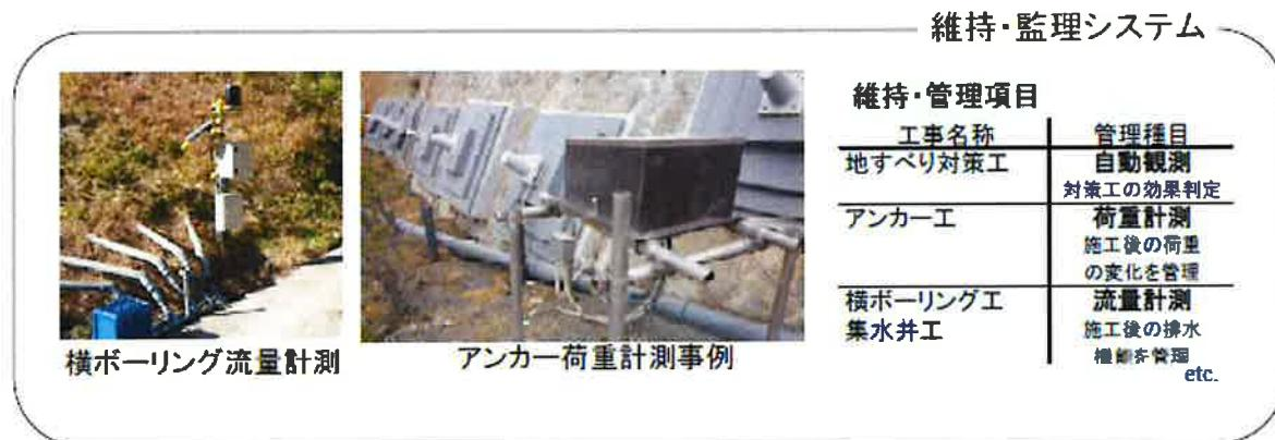
図3.3.3 治山施設の維持・管理システムの例：横ボーリング流量計測とアンカー荷重計測（国土防災技術 2018）
