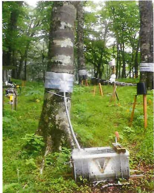
写真 3.2.1 樹幹流下量および林内雨量測定装置
