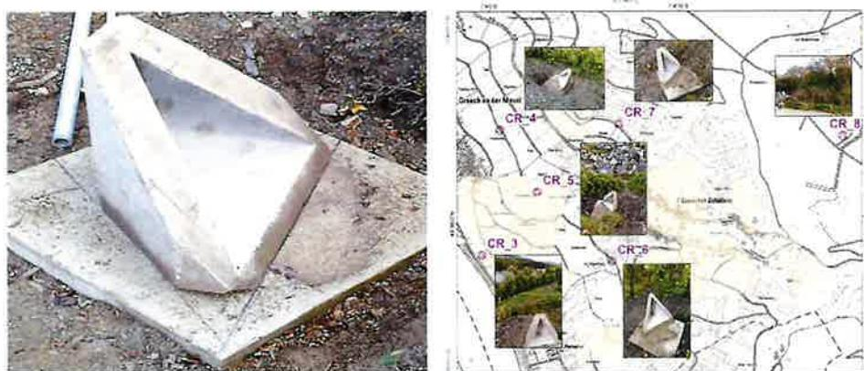
図 5.4.4 常時設置型コーナーリフレクタ(左) と設置例(右)(AIRBUS Defense and Space 2019b)。
