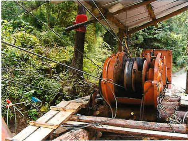
図 3-49 集材機と盤台の状況
