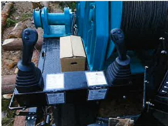
図 2-23 油圧式集材機操作レバー
