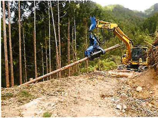
図 2-14 T木材イワフジハーベスタによる造材
