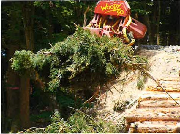
図 3-69 ハーベスタによる枝条の処理
