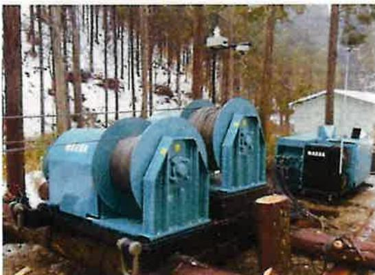
図 2-25 ユニット化された油圧式集材機
