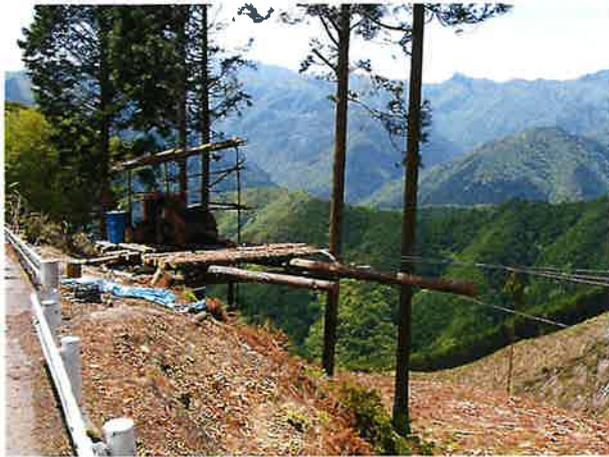
図 3-56 集材機と盤台の状況
