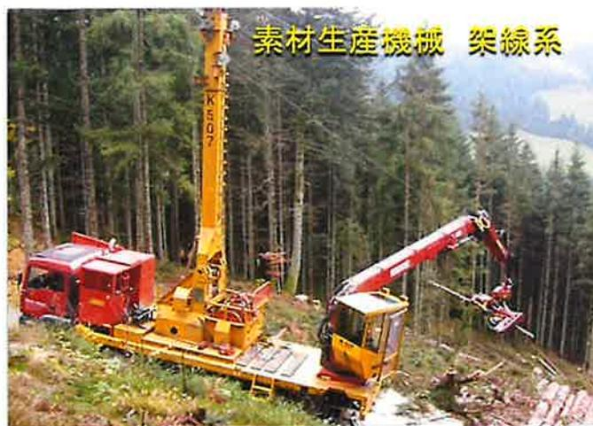
図 2-64 素材生産用の架線系機械としてタワーヤーダ
