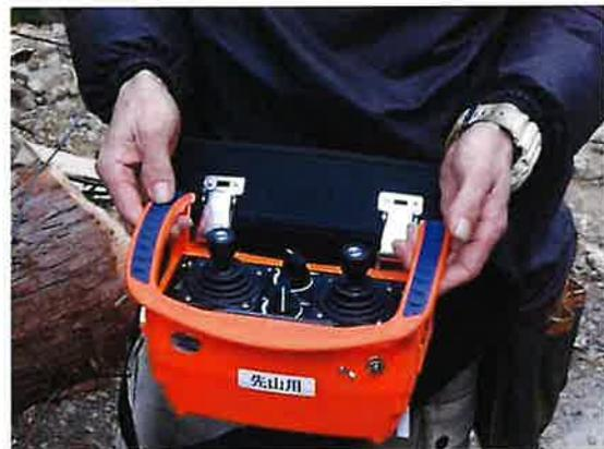
図 2-24 油圧式集材機のリモコン装置
