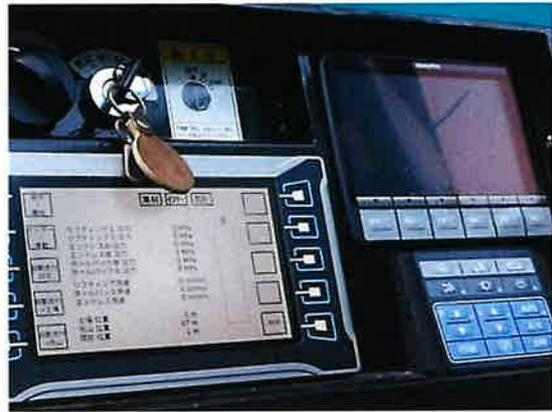
図 2-21 油圧式集材機の制御モニタ
