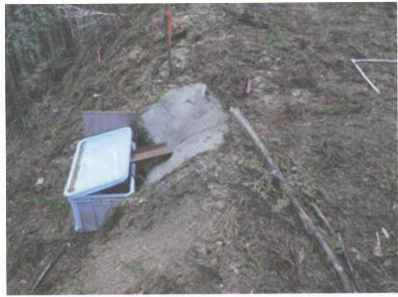
横断排水溝からの流出土砂受け装置（森林総研）
